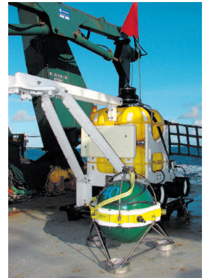
Een van de seismometers voordat deze vanaf een schip afdaald naar de zeebodem rond Hawaï. FOTO GABRIELSKA
