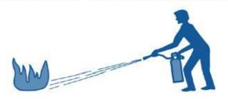
3. SQUEEZE HANDLES TOGETHER AND SWEEP THE EXTINGUISHER STREAM SIDE TO SIDE
